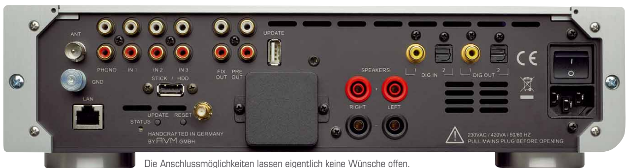
Die Anschlussmöglichkeiten lassen eigentlich keine Wünsche offen. Lautsprecherkabel benötigen allerdings Bananenstecker
